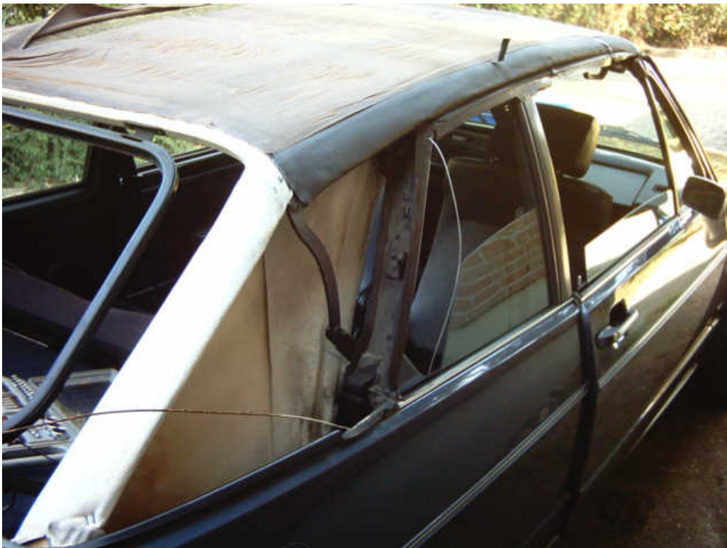
Abbildung 6: Heckscheibenrahmen mit Gestänge
