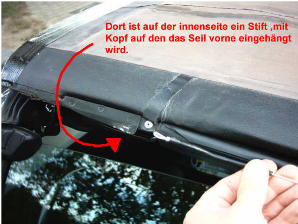
Abbildung 3: Vorderer Einhängpunkt des seitlichen Spannseils
