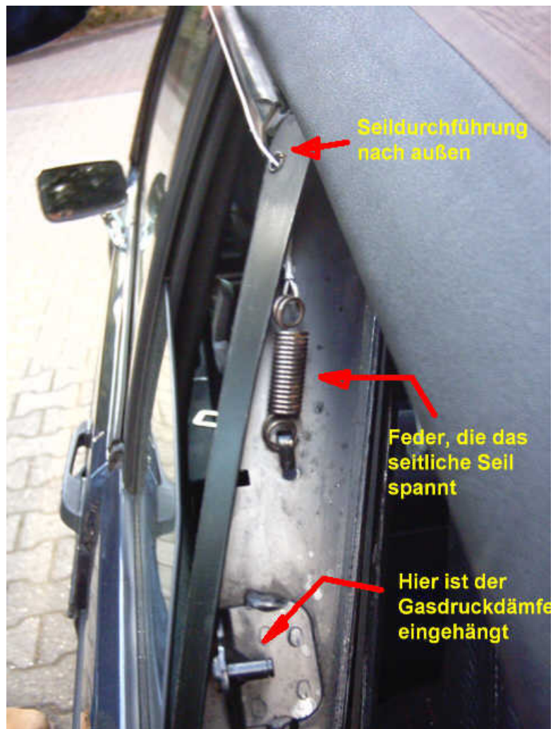
Abbildung 2: Einhängpunkt hinten seitliches Spannseil
